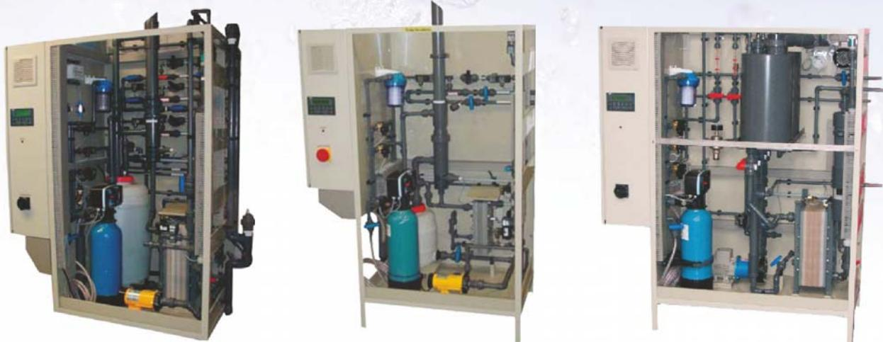
Prema principu rada elektrolizeri se mogu svrstati u dve grupe, sisteme sa cevastom čelijom i sisteme za membransku elektrolizu. Kod čelijskih sistema elektroliza se odvija u zajedničkoj komori u kojoj se nalaze obe elektrode, dok se kod membranskih odvija u dve komore sa elektrodama koje su odvojene membranom.
