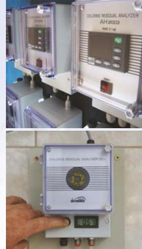
Analizator rezidualnog hloru AH-2003 testiran je i dokazan kao pouzdan uređaj za kontinualno, precizno merenje reziduala. Uređaj radi na amperometrijskom principu i dizajniran je da kontinualno meri slobodni hlor u vodi, plivačkim bazenima ili u raznim procesnim aplikacijama.
