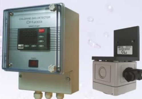
Detektor hlora u vazduhu registruje i meri (uz digitalno pokazivanje) pojavu hlora u skladištu hlora i daje signal za automatsko uključivanje uređaja za neutralizaciju, ako koncentracija gasnog hlora u vazduhu premaši max dozvoljenu vrednost. Zvučni opominjući signal projektuje se za samu pojavu hlora u skladištu hlora, a ako koncentracija hlora premaši zadatu
