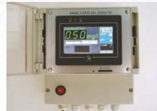
Analizator rezidualnog hlora AH-2003/10 testiran je i dokazan kao pouzdan uređaj za kontinualno, precizno merenje reziduala. Uredaj radi na amperometrijskom principu i dizajniran je da kontinualno meri slobodni hlor i temperaturu u vodi, plivačkim bazenima ili u raznim procesnim aplikacijama.
