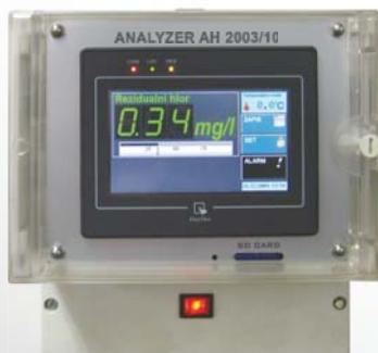
Elektronika analizatora hlora
