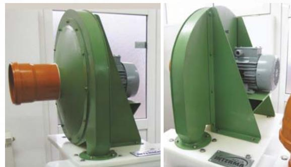
Ventilator upotrebljen za ovu svrhu mora da zadovolji još jedan bitan uslov a to je savlađivanje velikog pada pritiska u aparatu koji nastaje kao posledica stuba tečnosti iznad otvora na distributeru putem kojih se gasna smeša uvodi u neutralizujući rastvor. Ovo iziskuje korišćenje visokopritisnog radijalnog ventilatora s tim što svi delovi koji dolaze u dodir sa smešom gasnog hlora i vazduha moraju biti otporni na dejstvo hlora.
