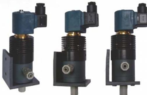
Koristi se u sistemima za poluautomatski rad. Kada se hlorisanje vrši u više paralelnih distributivnih linija od kojih svaka ima sopstvenu pumpu, pojedinačnim uključenjem napojnih pumpi uključuje se i elektromagnetni ventil, a samim tim dolazi i do promene u doziranju hlora.
