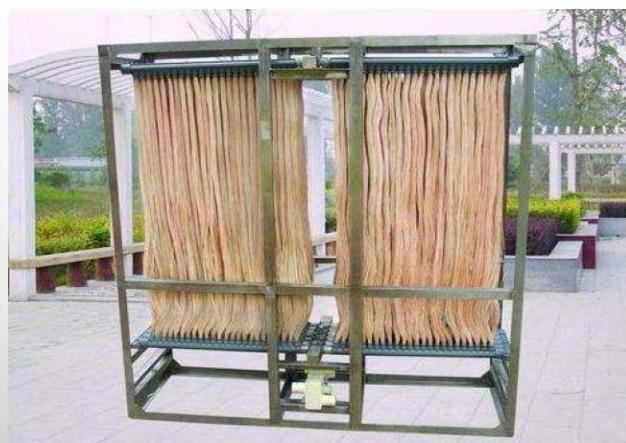
Membranski bioreaktor za prečišćavanje otpadnih voda funkcioniše kroz kombinovani proces aerobnog biološkog prečišćavanja i ultrafiltracionog tretmana.
